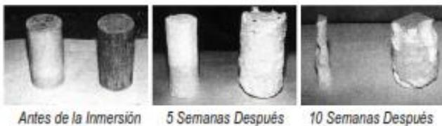
El mortero tratado con Xypex y otro sin tratamiento se sometieron a prueba de resistencia al ácido siendo expuestos a una solución de 5% H<sub>2</sub>SO<sub>4</sub> durante 100 días. Xypex disminuyó la erosión del concreto hasta 1/8vo respecto a las muestras de referencia.
